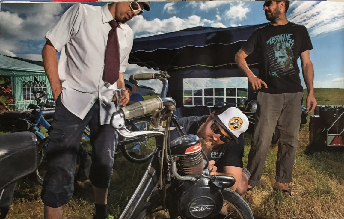
Au stand Avant le départ, dernier réglage sur un VéloSolex 3800, le modèle légendaire de la marque. Commercialisé de mai 1966 à novembre 1988, il sera vendu à plus 1 115 000 exemplaires. Avec son moteur d'une puissance de 0,8 ch à 2500 tours, il atteint la vitesse de 35 km/h. Dessous, Jacques Delarue, alias Jacques 1 er , prince du carnaval de Bienne 2018, réconforté par une spectatrice.
